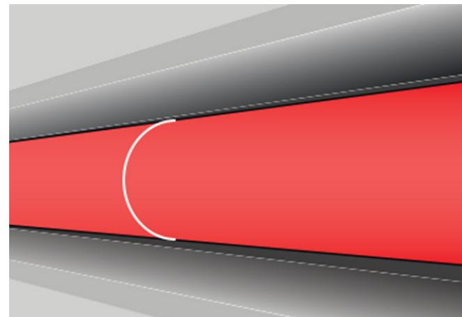
4.19.6. Проклеить шов самоклеящейся армированной клейкой лентой для герметизации соединения.
